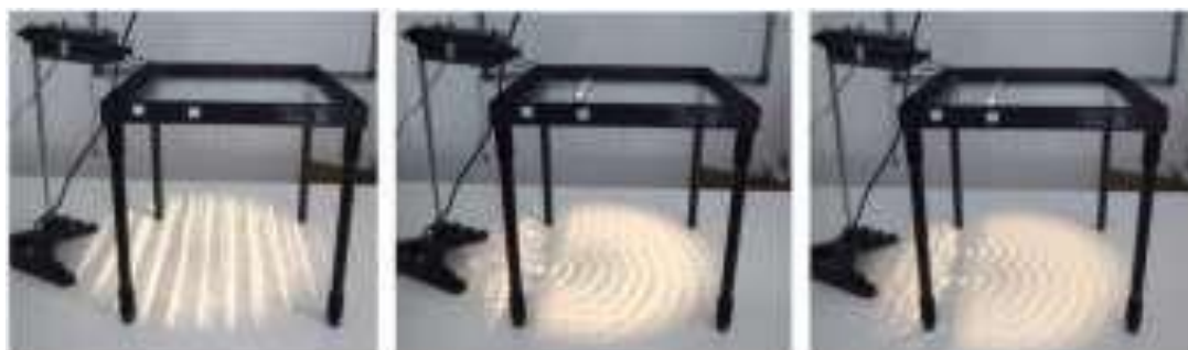
Εικόνα 6 Η συσκευή κυματισμών με το νερό στο πάνω μέρος (πάνω σε μια γυάλινη επιφάνεια) χρησιμοποιείται για να διατυπωθούν στους φοιτητές ερωτήσεις σχετικές με τα κύματα επιφάνειας και την συμβολή των υδάτινων κυμάτων (Κάτοχος φωτογραφικών δικαιωμάτων: Π. Λάζος) [Calibri, Bold Italics 9, διάστημα πριν την παράγραφο 6 στ., διάστημα μετά 12 στ.]
