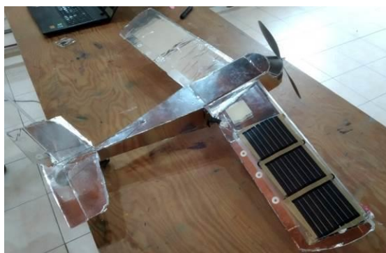
Εικόνα 1 Το αεροπλάνο με το ηλιακό πάνελ στο φτερό
