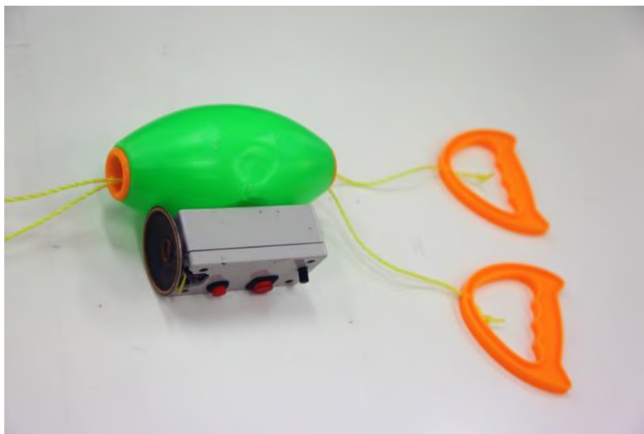
Εικόνα 2 Το κουτί με το κύκλωμα πάνω στην «μπάλα». Διακρίνονται το ηχείο, το ποτενσιόμετρο, οι διακόπτες και οι λαβές του ενός παίκτη
