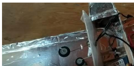
Εικόνα 3 Το σύστημα ελέγχου κίνησης στο εσωτερικό της ατράκτου
