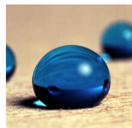
Εικόνα 3: Εικόνα δραστηριότητας 238 : σταγόνα πάνω σε υπέρ- υδρόφοβο ξύλο
