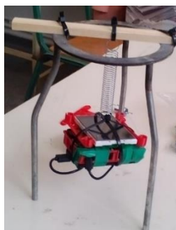
Εικόνα 1: Ο επιταχυνσιογράφος που κατασκεύασε η ομάδα των μαθητών στο πλαίσιο του διαγωνισμού «Φτιάξε το δικό σου σειсмоγράφο».
